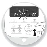
3- Regel de parameter(s) met behulp van de '+/-'-schakelaar (**B6**).
