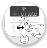
4- Cuando haya terminado de modificar todos sus parámetros, pulse el botón «start» (B5) para iniciar el programa. Cuando su aparato utiliza el modo de cocción, el testigo luminoso rojo se enciende para informarle de que la cocción se ha iniciado.
