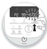
1 - Pulse directamente el selector del parámetro que desee ajustar, es decir, el selector de velocidad **(B1)**, el selector de temperatura de cocción **(B2)** o el selector de tiempo **(B3)**, el parámetro elegido parpadea en la pantalla **(C5-C6-C7)**.
