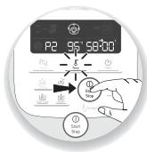
3 - Cuando haya terminado de ajustar todos sus parámetros, pulse el botón «start» **(B5)**. Cuando su aparato utiliza el modo de cocción, el testigo luminoso rojo se enciende para informarle de que la cocción se ha iniciado. Cuando se inicia la programación, tiene la posibilidad de detener el aparato en cualquier momento pulsando el botón «stop» **(B5)**.
