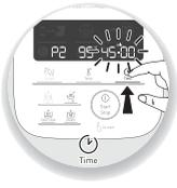
1- Drücken Sie auf die Auswahltaste der Einstellung, die Sie ändern möchten: den Geschwindigkeitsregler **(B1)** oder den Gartemperaturregler **(B2)** oder den Zeitregler **(B3)**. Daraufhin blinkt der ausgewählte Parameter auf der Anzeige auf **(C5- C6-C7)**.
