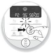
3- Wanneer u al uw parameters heeft ingesteld, drukt u op de 'start'-knop **(B5)**. Wanneer uw apparaat in werking is getreden, licht het rode controlelampje op om
