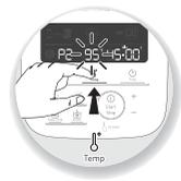
2- Les paramètres pré-programmés peuvent être modifiés le temps d'une recette (selon la recette choisie, les ingrédients, les quantités préparées). Appuyez sur le sélecteur température de cuisson (B2) ou le sélecteur temps (B3), le paramètre choisi clignote à l'écran (C6-C7).
