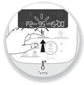
2- De voorgeprogrammeerde parameters kunnen worden gewijzigd tijdens de bereiding van een recept (in functie van het gekozen recept, de ingrediënten en de hoeveelheden). Druk op de keuzeschakelaar bereidingstemperatuur (**B2**) of de tijdkeuzeschakelaar (**B3**); de gekozen parameter knipper op het scherm (**C6-C7**).
