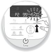
1- Druk op de schakelaar van de parameter die u wilt instellen (de snelheidsschakelaar **(B1)**, de temperatuurschakelaar **(B2)** of de tijdschakelaar **(B3)**). De gekozen parameter knippert op het scherm **(C5-C6-C7)**.
