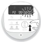
2 - Regolare i parametri servendosi del selettore +/- **(B6)**. Per sicurezza, non è possibile regolare la temperatura senza regolare i tempi di cottura.
