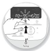
2- Los parámetros preprogramados pueden modificarse mientras se elabora una receta (en función de la receta elegida, los ingredientes y las cantidades preparadas). Pulse en el selector de temperatura de la cocción (B2) o el selector de tiempo (B3), el parámetro escogido parpadeará en la pantalla (C6-C7).
