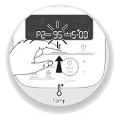
2- Le impostazioni preprogrammate possono essere modificate per una sola ricetta (in base ricetta scelta, gli ingredienti, le quantità). Premere il selettore della temperatura di cottura (B2) o il selettore del tempo (B3), il parametro prescelto lampeggia sullo schermo (C6-C7).
