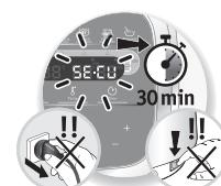
O seu aparelho está equipado, de série, com proteções eletrónicas do motor por forma a garantir a sua longevidade. Esta segurança eletrónica protege-o contra qualquer utilização anormal; desta forma, o seu motor fica totalmente protegido.
