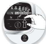
1 - Premere direttamente sul selettori del parametro che si è scelto di regolare, ovvero quello della velocità (B2), quello del selettore della temperatura di cottura (B3) o sul selettore del tempo (B4): il parametro scelto lampeggia sullo schermo (C1-C2-C3).
