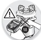
• No ponga el aparato en funcionamiento si la junta no está colocada sobre su soporte, si dicho soporte no está montado en la tapa. Resulta imperativo utilizar el aparato con el tapón colocado en el orificio de la tapa (salvo en caso de información específica de la receta).
