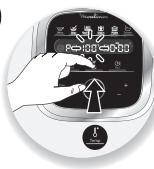
2- Los parámetros preprogramados pueden modificarse mientras se elabora una receta (en función de la receta elegida, los ingredientes y las cantidades preparadas). Pulse el selector de velocidad (B2), el selector de temperatura de cocción (B3) o el selector de tiempo (B4), el parámetro elegido parpadea en la pantalla (C1-C2-C3).
