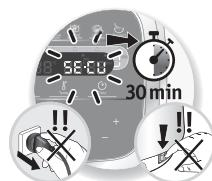
در شرایط بسیار شدید استفاده، یا در آمد شخصی (اینترنت و غیره ...)، عدم رابطه توصیه های جزو (بخش "راه اندازی": مقابله بیش از حد بزرگ و / یا استفاده از حد نزدیک را مشاهده و / یا ترتیب دستور العمل های بیش از حد نزدیک حفظ موتور فعال می شود. کنید)، حفاظت الکترونیکی برای حفظ موتور فعال می شود. در این مورد، واحد توقف متوقف می شود و نمایش "SECU" در پانل کنترل LCD ظاهر می شود تا نشان دهد که دستگاه به طور لحظه ای قابل استفاده است. بر روی پانل کنترل نشان داده شود و دستگاه شما کار کردن را
