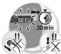
Ihr Gerät ist serienmäßig mit elektronischen Motorschutzfunktionen ausgestattet, um seine Langlebigkeit zu gewährleisten. Diese elektronische Sicherung schützt Sie vor jeglicher abnormaler Verwendung. So ist Ihr Motor perfekt geschützt.
