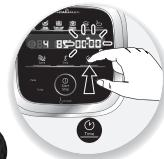
1- Druk op de schakelaar van de parameter die u wilt instellen (de snelheidsschakelaar (B2), de temperatuurschakelaar (B3) of de tijdschakelaar (B4). De gekozen parameter knippert op het scherm (C1-C2-C3).
