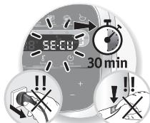
L'apparecchio è dotato, di serie, di protezioni elettroniche del motore per garantire la sua durata. Questa sicurezza elettronica garantisce contro qualsiasi utilizzo anomalo; in tal modo il motore è perfettamente protetto.
