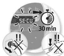
De motor van uw apparaat is standaard elektronisch beveiligd, om ervoor te zorgen dat u het apparaat zo lang mogelijk kan gebruiken. Dankzij deze elektronische
