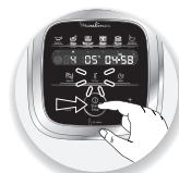
3- Wanneer u al uw parameters heeft ingesteld, drukt u op de 'start'-knop (B7). Wanneer uw apparaat in werking is getreden, licht het rode controlelampje (B3) op om
