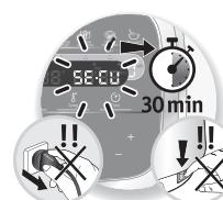
u aparato viene equipado e serie con protecciones electrónicas del motor para garantizar su longevidad. Esta seguridad electrónica está garantizada contra cualquier utilización anormal; así su motor está perfectamente protegido.
